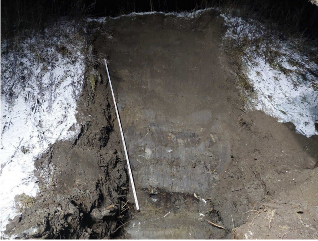
Orgaanista täyttömaata/multaa Orgaanista täyttömaata/multaa/hieman savea Kunntaa, juuria Savista hiekkaa, isoja kiviä ja mahdollisesti kalliota
