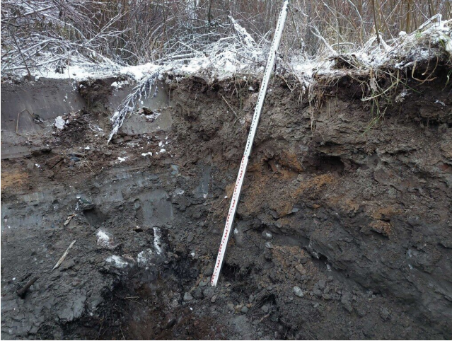
Orgaanista täyttömaata/mullansekaista hiekkaa ja kiviä, mursketta Karkeaa kiveä, savea, hiekkaa Kunttaa, juuria, orgaanista ainesta, kiviä, soraa. Kallio
