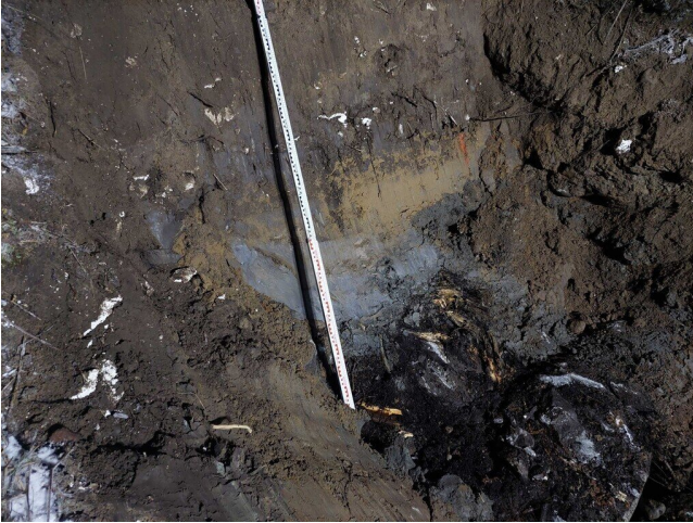
Orgaanista täyttömaata/mullansekaista hiekkaa ja kiviä Hiekkakerros Savikerros Kuopan pohjalla kunttaa, juuria ja isoja kiviä
