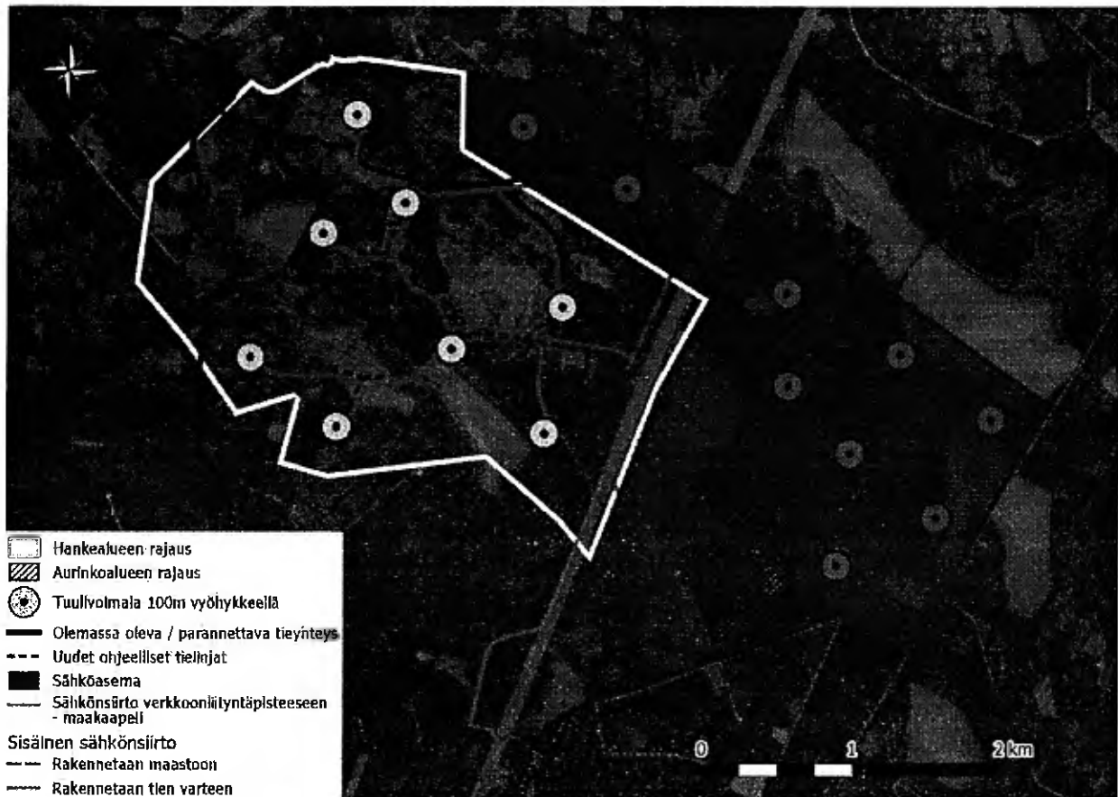
Kuva 47. Ilmakuvasta nähdään, kuinka suunniteltu uusi tiestö ja sen yhteyteen rakentuvat sähkönsiirron maakaapelit suhtautuvat nykyiseen maankäyttöön. Kaava-alueen sisäinen sähkönsiirto järjestetään maakaapeleilla pääosin myllyjen huoltoteiden yhteyteen. Sähkönsiirto Uusnivalan sähköasemalle toteutetaan olemassa olevan voimalinjan yhteyteen, jolloin maisemaan ei synny hankkeen myötä uutta voimalinja-aukeaa (kaava-alueen ulkopuolinen alue merkitty punaisella rasterilla).
