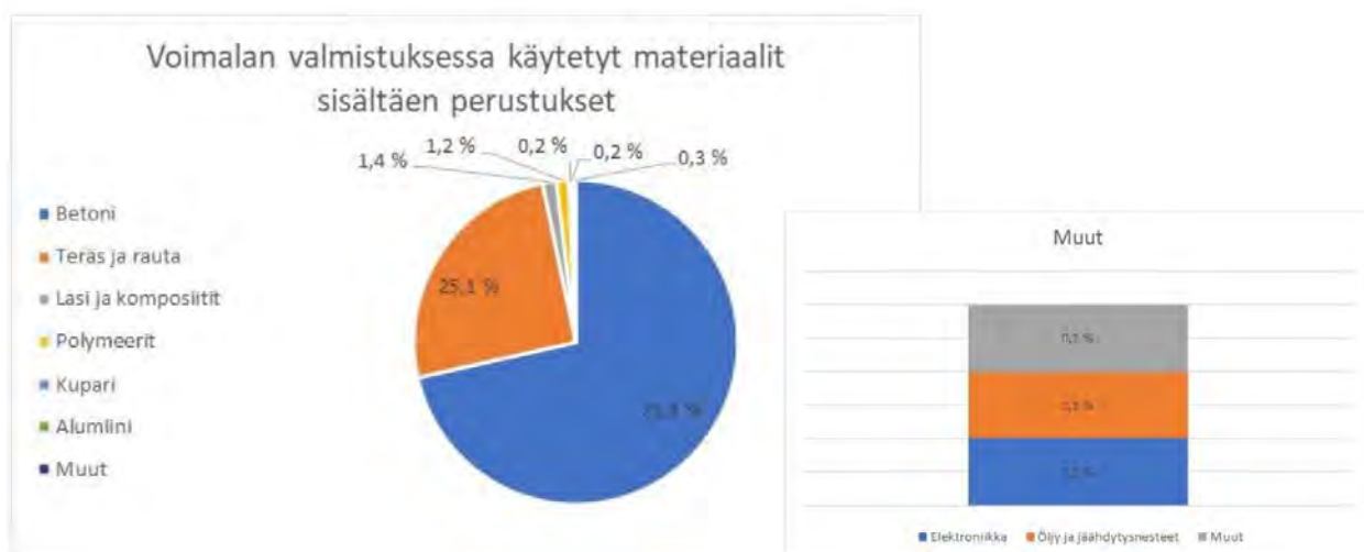
Kuva 144. Esimerkki voimalan valmistuksessa käytettävistä materiaaleista sisältäen voimalaperustukset ja niiden osuus koko voimalan massasta Voimalamalli Vestas V150-4,2 MW (Vestas 2022b)
