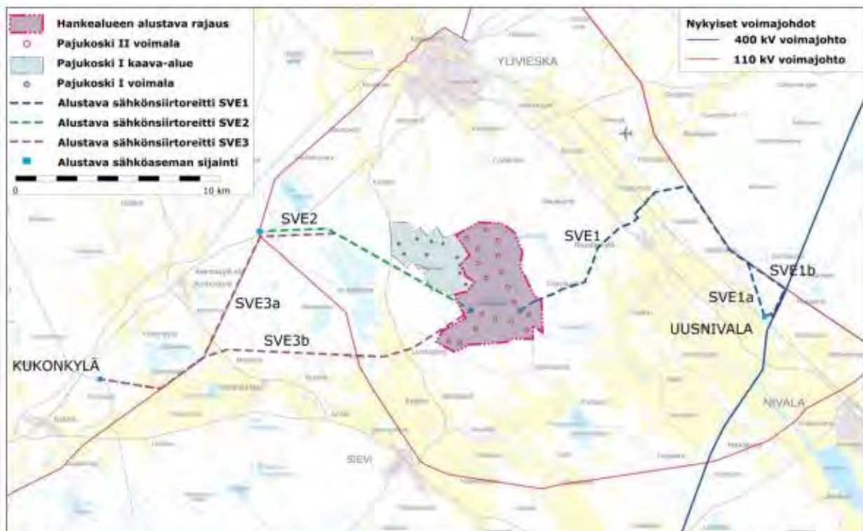
Kuva 5: Sähkönsiirron alustavat reittivaihtoehdot.
