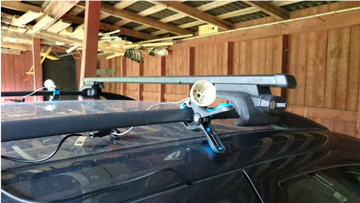
Kuva 3.3. Auton katolle sijoitetut mikrofonit tuulisuojiin.
