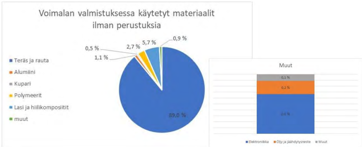
Kuva 139. Esimerkki voimalan valmistuksessa käytettävistä materiaaleista pois lukien voimalaperustukset ja niiden osuus koko voimalan massasta Voimalamalli Vestas V150-4,2 MW. (Vestas 2022b)
