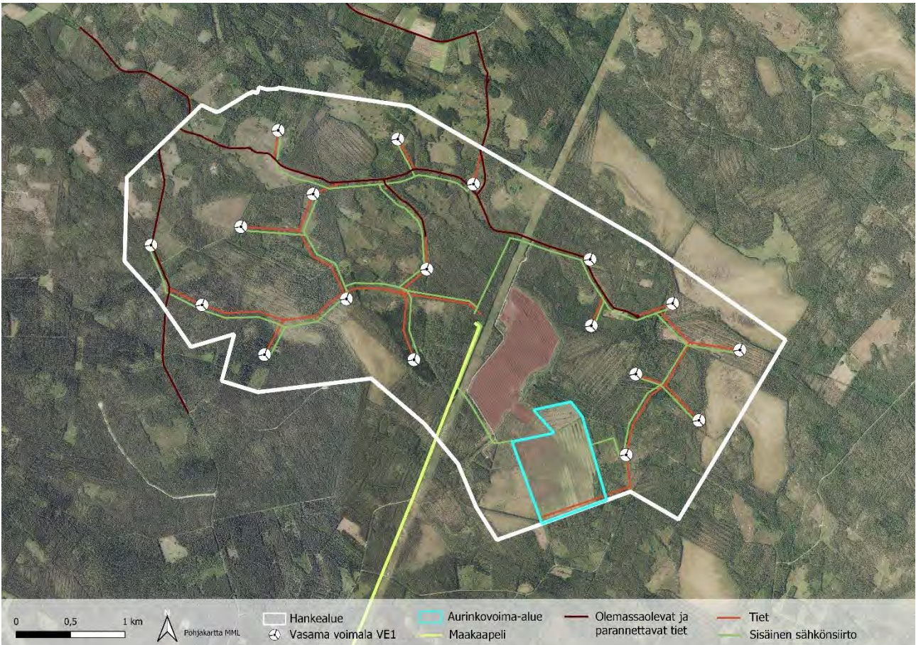
Kuva 43. Ilmakuvaista nähdään, kuinka suunniteltu uusi tiestö ja sen yhteyteen rakentuvat sähkönsiirron maakaapelit suhtautuvat nykyiseen maankäyttöön. Hankealueen sisäinen sähkönsiirto järjestetään maakaapeleilla pääosin myllyjen huoltoteiden yhteyteen. Sähkönsiirto Uusnivalan sähköasemalle toteutetaan olemassa olevan voimalinjan yhteyteen, jolloin maisemaan ei synny hankkeen myötä uutta voimalinja-aukeaa.
