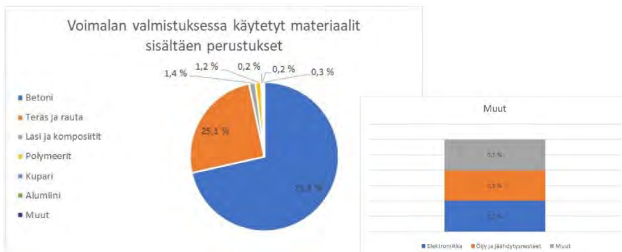
Kuva 116. Esimerkki voimalan valmistuksessa käytettävistä materiaaleista sisältäen voimalaperustukset ja niiden osuus koko voimalan massasta Voimalamalli Vestas V150-4,2 MW (Vestas 2022b)
