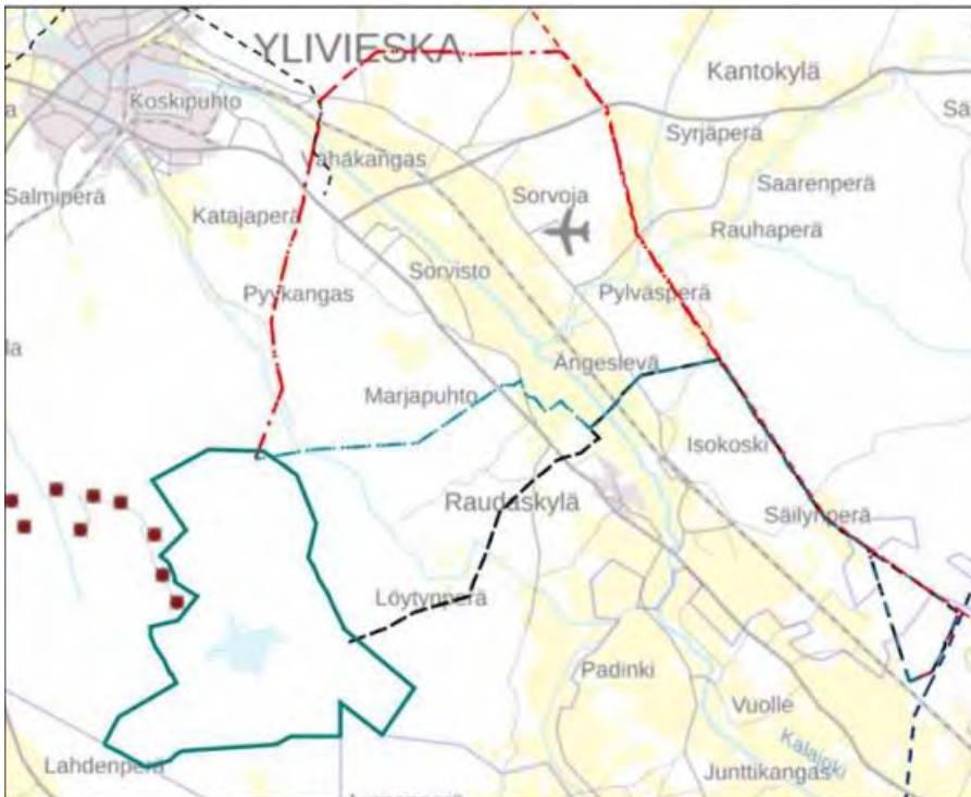
Kuva 121. Hankkeen esisuunnittelussa tarkasteltuja sähkösiirron ilmajohtoreittejä Uusnivalan sähköasemalle. YVA-menettelyssä ja sähkösiirtoreitin jatkotarkastelussa on mukana eteläisin (musta katkoviiva) esiselvityksen reiteistä (Kartta: OX2, Lähde: Ylivieskan Pajukoski II tuulivoimapuisto, Ympäristövaikutusten arviointiohjelma 16.9.2022 s. 16).
